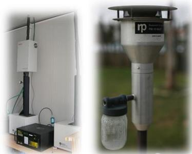
Préleveur de particules (installé en cabine de mesure) et tête de prélèvement extérieure.
