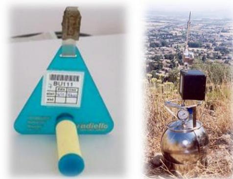
Dispositifs de mesure du benzène (« tube benzène et canister »).
